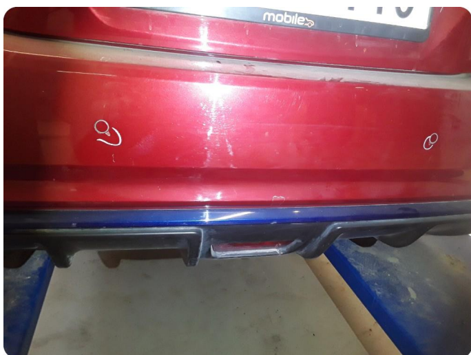
2.3 Lakk flasser Og riper ned til grunning
