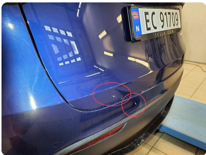
3.2 Bulk med lakkskade /en liten ripe ned til grunning støtfanger venstre bak
