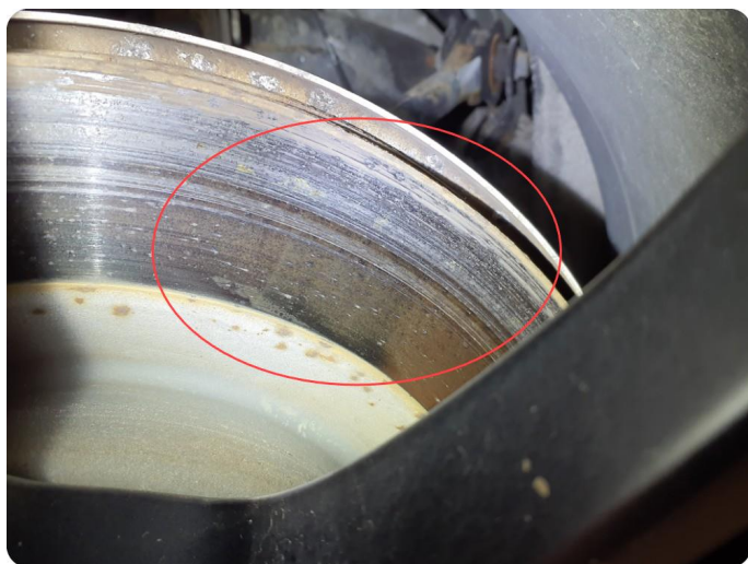
5.1 Mer enn 25% rust Mer enn 50% innerside høyre
