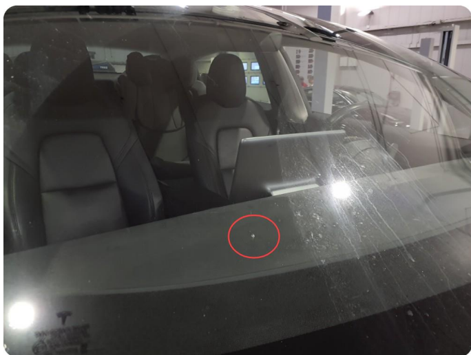
3.6 Steinsprut med sprek
