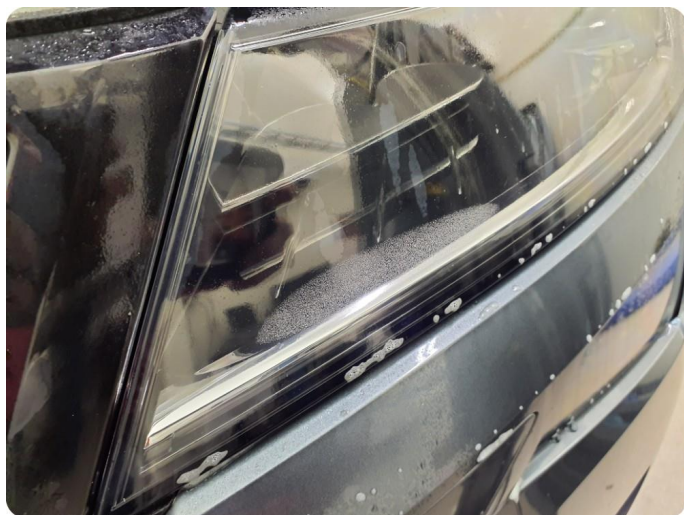
4.1 Dugg/fukt Fukt I begge hovedlamper
