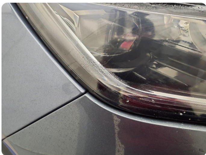
4.1 Dugg/fukt Fukt I begge hovedlamper
