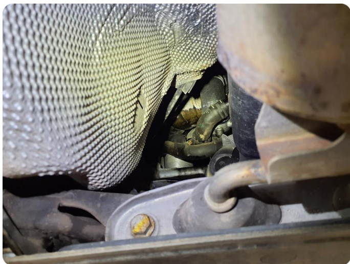
5.2 Svetter Motor svetter, må kontrolleres
