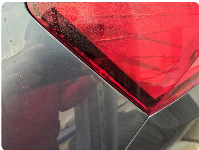
4.3 Krakelering i plast Krakelering I baklampe
