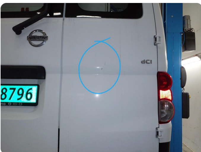
2.4 Rust/korrosjon Ufagmessig forsøkt reparert
