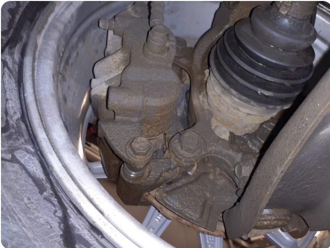
6.1 Slitte/stor slitekant Og rust
